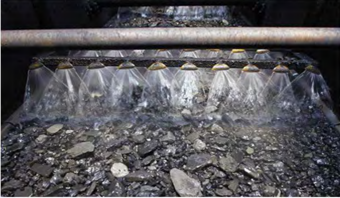
Fotoğraf 2.1: Örnek Bir Konveyör Bant Su Spreyleme Sistemi
