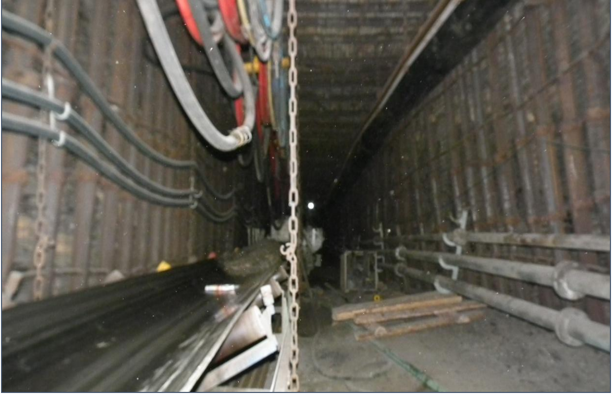
Şekil I.33: Örnek Bir Tavan, Taban Yolu Galerisi Bant Konveyör Nakli
