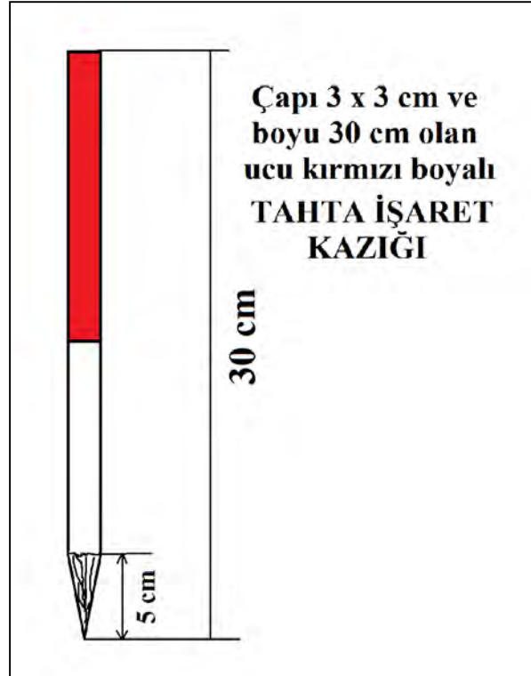
Şekil 2.1: Toprak Altı Yapıların Yerinin Tespit Edilmesinde Kullanılacak İşaret Kazığı
