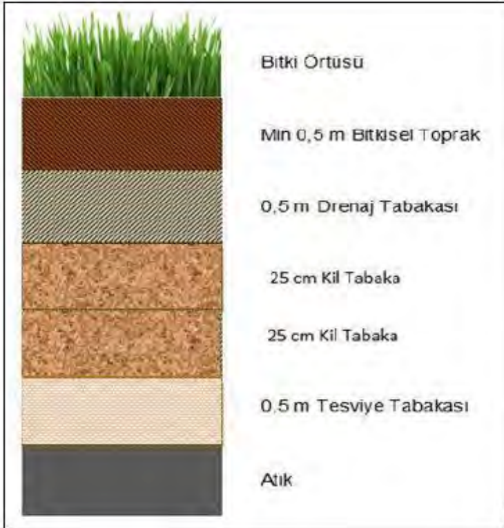
Şekil- 8: Depolama Sonu/Kapatma Üst Örtü Tasarımı
